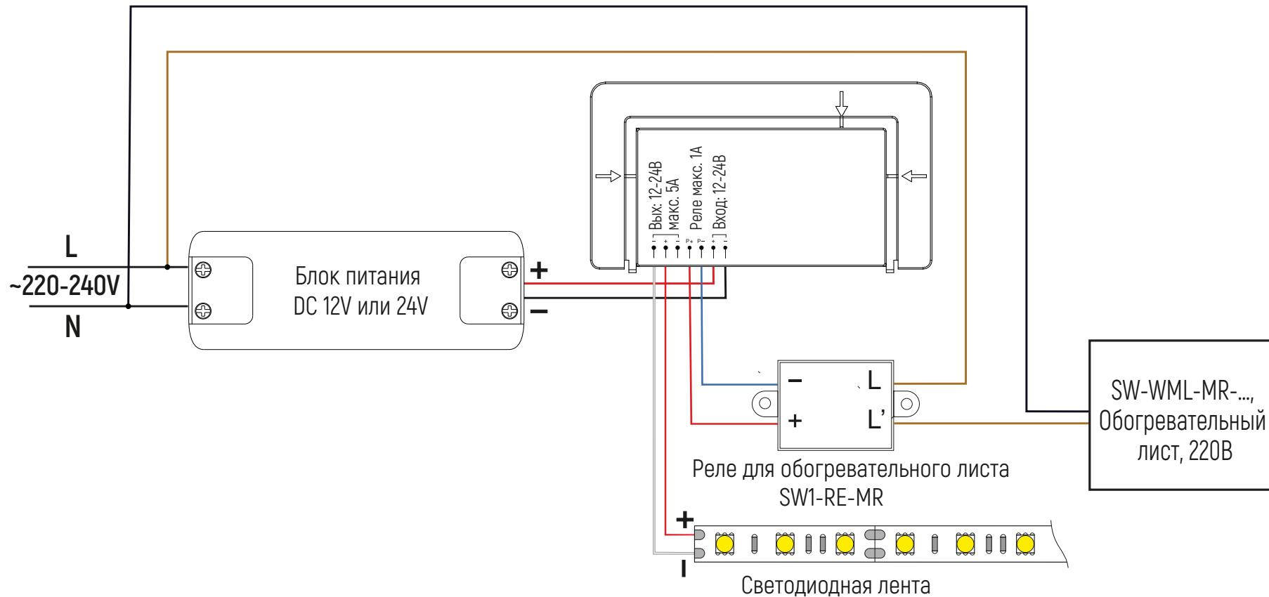
**Схема подключения светодиодной ленты 12В или 24В
