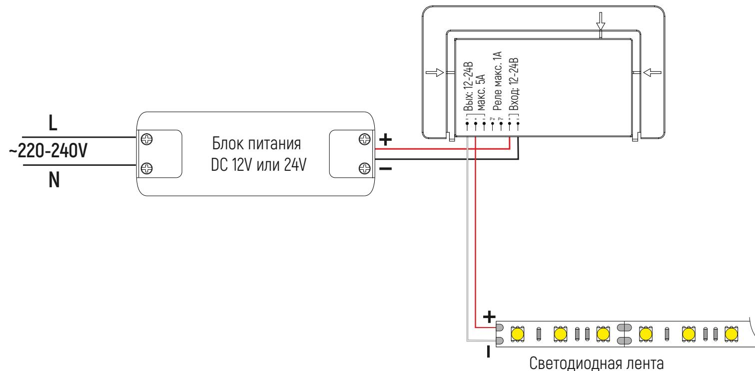
**Схема подключения светодиодной ленты 12В или 24В
