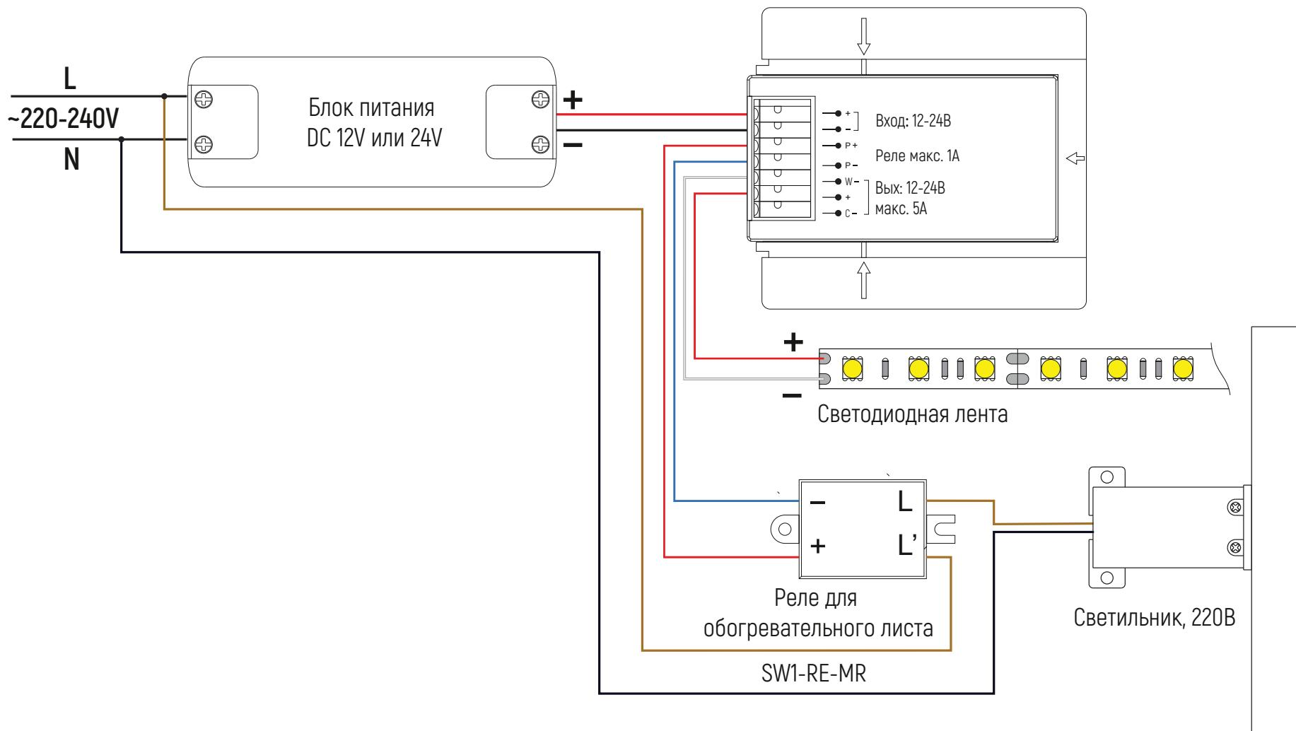
**Схема подключения светодиодной ленты 12В или 24В
