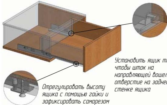
Установить ящик так, чтобы шток на направляющей вошел в отверстие на задней стенке ящика
