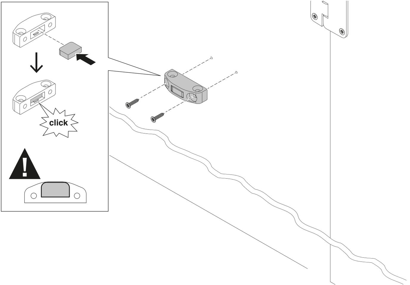
**Предварительная подготовка механизма автоматического открывания**
