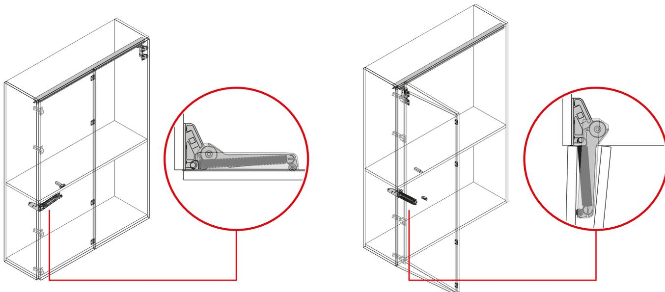
**PS23 Механизм автоматического открывания от нажатия**
