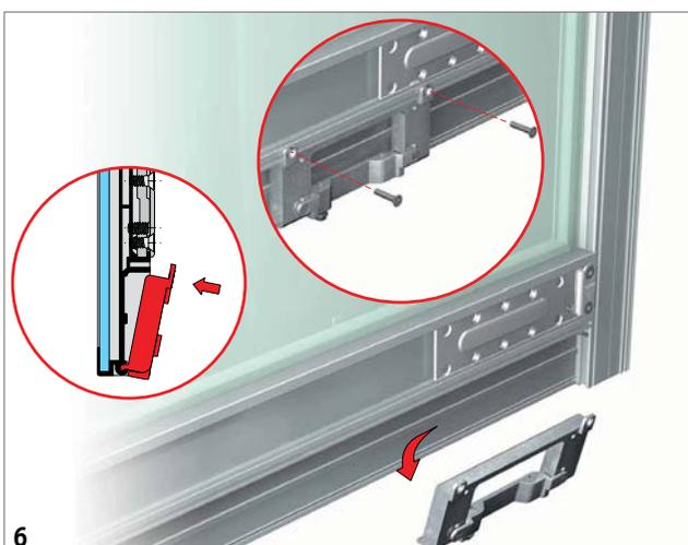
**1** Соедините профиль-ручку и горизонтальный профиль с помощью крепежных элементов.
