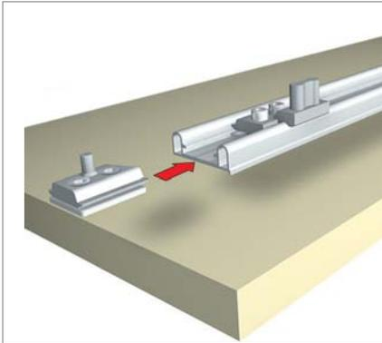
Установка стопора и активаторов в верхнюю направляющую
