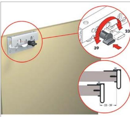
Установка ручки-стопора на внутреннюю дверь
