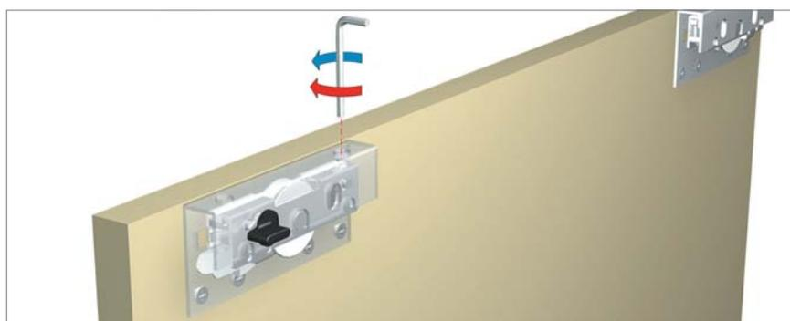
Регулировочный винт верхних роликов находится в их верхней части. При выкручивании винта шестигранным ключом в направлении голубой стрелки дверь поднимается; при закручивании в направлении голубой стрелки дверь опускается.
