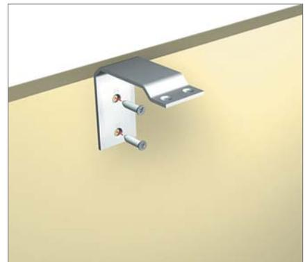
Монтаж крепления для доводчика на внешнюю дверь
