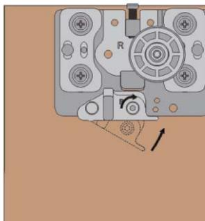
9.4. Зафиксируйте нижний ролик
