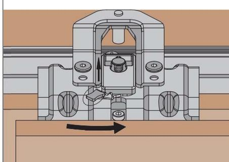
10.3. Активируйте фиксатор нижнего ролика
