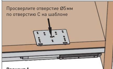
Просверлите отверстие по шаблону и зафиксируйте
