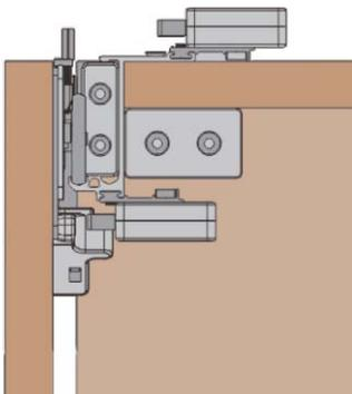
9.3. Активируйте механизм против соскакивания и затяните фиксирующий винт
