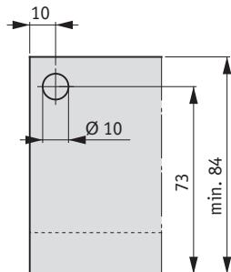
**Раскройные размеры дна и задней стенки ящика (ДСП 16 мм)**
