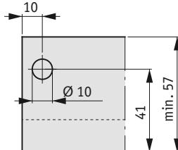
**Раскройные размеры дна и задней стенки ящика
