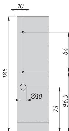
**Раскройные размеры дна и задней стенки ящика (ДСП 16мм)**
