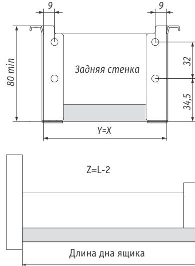
**X** ширина дна ящика, мм;**Z** длина дна, мм;**Y** ширина задней стенки, мм;**L** длина боковины, мм.**K** внутренняя ширина корпуса, мм;
