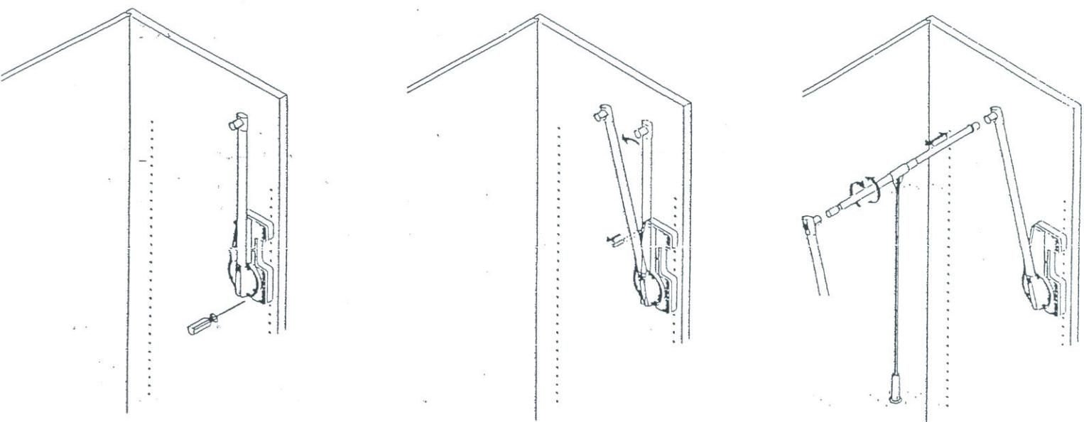
Quando l'abbassamento del braccio di LIFT 700 è ostacolato dalla presenza di cerniere sporgenti o da sportelli scorrevoli, è necessario applicare un distanziatore dello spessore di cm 2, che permette al braccio di superare gli ostacoli.
