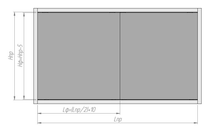
где Lnp – ширина проема, мм; Lф – ширина фасада, мм (min 300 мм); Нф – высота фасада, мм.
