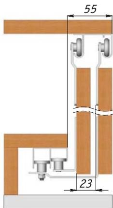
Смещение нижней направляющей относительно верхней при толщине дверей до  $18$  мм.
