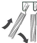
Регулировки толщины двери с помощью перестановки роликов в системе FUTURE
