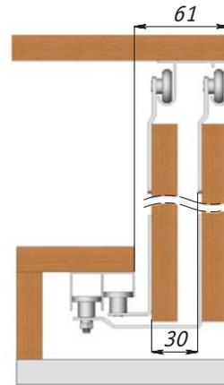
Смещение нижней направляющей относительно верхней при толщине дверей до  $25$  мм.
