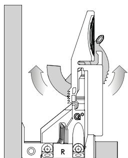
Регулировка глубины (макс. +3,5 мм)
