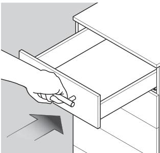
Слегка приподнять выдвижной ящик спереди и задвинуть до конца.
