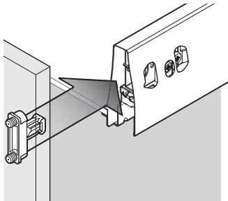
Задвинуть держатели фасадного профиля в торцы царги. Фасадный профиль защелкивается и фиксируется автоматически.
