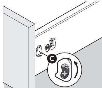
Отвернуть отверткой винт Pozl № 2.
