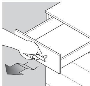
Вытянуть ящик и слегка приподнять, не доходя до ограничителя прим. на 10 см.
