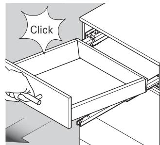
Вытянуть с усилием ящик горизонтально, пока он не разблокируется с характерным щелчком, затем опустить.
